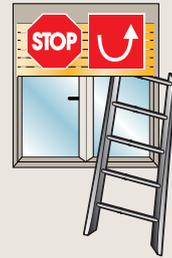
Trifft der motorisierte Rollladen nahe den Endlagen auf ein Hindernis, z.B. direkt unterhalb des Rollladenkastens oder kurz vor dem Fenstersims, schaltet Somfy Drive Control™ den Antrieb automatisch ab und hält den Rollladen in dieser Position. Eine anschliessende Fahrt ist nur in die Gegenrichtung möglich.
