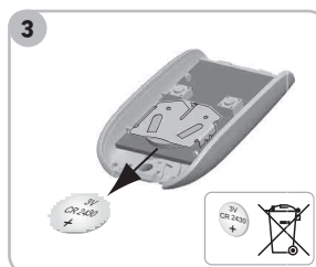
3 Retirer la pile à l'aide d'un tournevis.
