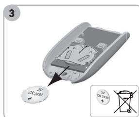
3 Retirer la pile à l'aide d'un tournevis.
