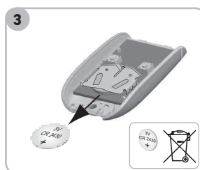
3 Retirer la pile à l'aide d'un tournevis.
