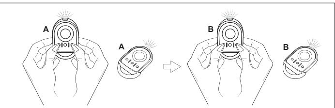
Uzaktan kumanda "A" = önceden hafızaya alınmış «kaynak» uzaktan kumanda
