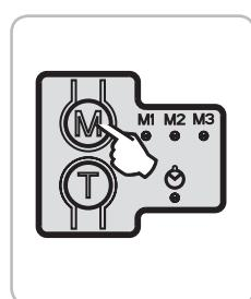
Kurzer Druck auf die Taste M, um vom sequenziellen Modus in den halb-automatischen Modus zu wechseln.
