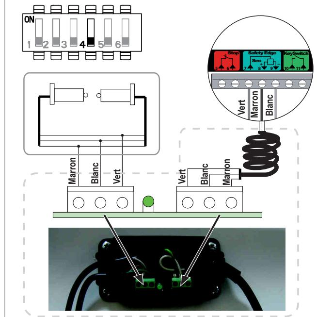
Si une barre palpeuse filaire remplace une barre palpeuse radio, l'émetteur barre palpeuse radio doit être effacé (voir partie 12) afin que la barre palpeuse filaire soit prise en compte.
