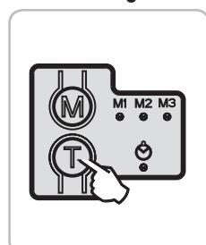
Kurzer Druck auf die Taste T, um eine der automatischen Schließfunktionen zu aktivieren.
