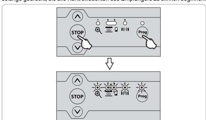
Zur Entsperrung der Programmertasten wiederholen Sie den oben beschriebenen Vorgang.
