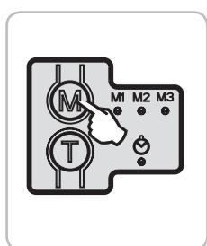
Appui bref sur la touche M pour passer du mode séquentiel au mode semi-automatique.
