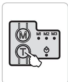
Appui bref sur la touche T pour activer une option de fermeture automatique.
