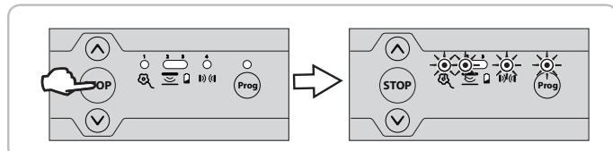
Lorsque le mode vacances est activé, chaque appui effectué sur une commande verrouillée (interface de programmation ou télécommande) provoque le clignotement des voyants 1, 2, 4 et Prog pendant 2 secondes.
