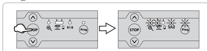
Wenn der Ferienmodus aktiviert ist, blinken bei jedem Druck auf einen verriegelten Funksender (Programmierschnittstelle oder Fernbedienung) die Leuchten 1, 2, 4 und Prog 2 Sekunden lang.
