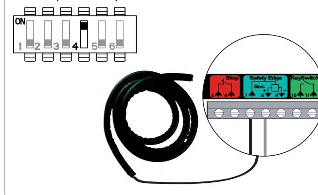
**!** Si une barre palpeuse filaire remplace une barre palpeuse radio, l'émetteur barre palpeuse radio doit être effacé (voir partie 12) afin que la barre palpeuse filaire soit prise en compte.
