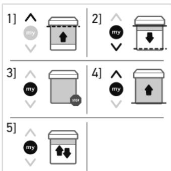
[1] اضغط مطرّلاً على زر Up لتحريك المنتج المجهّز بمحرك إلى موضع الرفع المرغوب به. عند الحاجة، اضبط موضع الرفع باستخدام الزر Up أو الزر Down.
