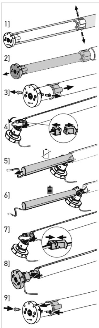
**9]** Βιδώστε την κεφαλή του μοτέρ χρησιμοποιώντας τις σταυρόβιδες στο σωλήνα του μηχανισμού.
