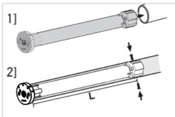
[1] اجعل المحرك ينزلق داخل الأنبوب. أدخل العجلة عن طريق محاذاة العجلة إلى سطح الأنبوب. أدخل المحرك حتى المنتصف ثم اجعل التاج ينزلق أسفل المحرك وأدخله في الأنبوب. ختاماً، ادفع المحرك داخل الأنبوب.
