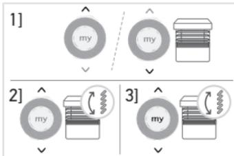
1] باستخدام زر **Up** أو زر **Down** بجهاز التحكم، حرّك المنتج المجهّز بمحرك بعيداً عن الحدود الطرفية.
