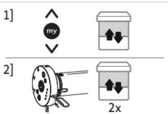
2] **Para activar la radiotecnología «RTS» Somfy:** Pulse brevemente el botón de programación del cabezal de la motorización hasta que el producto automatizado efectúe dos breves movimientos de subida y bajada y el LED verde parpadee 5 veces.
