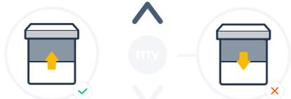
Si le volet roulant monte, le sens de rotation est **correct**, passez au chapitre suivant.
