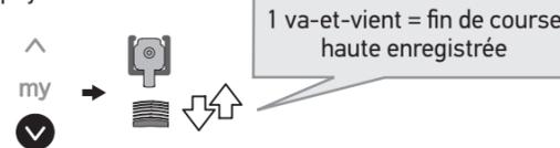
① Si lors d'un cycle, la fin de course haute s'est modifiée automatiquement, alors la fonction de réajustement automatique est activée.
