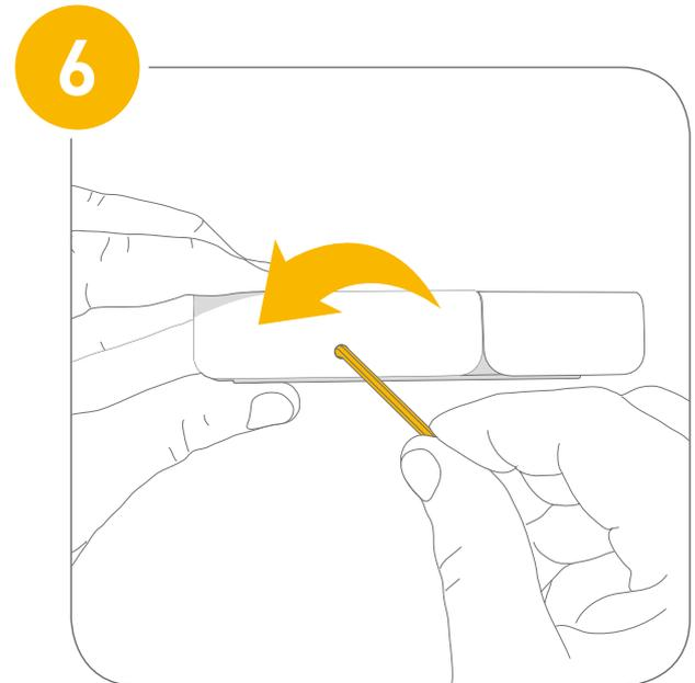
Verrouillez le capot à l'aide de la clé Allen en effectuant une rotation vers la gauche.
