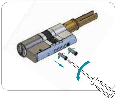
En fonction de la configuration à obtenir, utilisez le tournevis T-10 fourni pour dévisser la vis de fixation située sous la partie métallique P2 ou P3.
