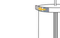
13) Wprowadź wałek napędu do otworu koła pasowego.
