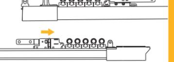
9) Fissare le viti sul carrello di trascinamento.
