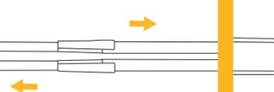
3) Resserrer la vis sur le raccord de rail.
