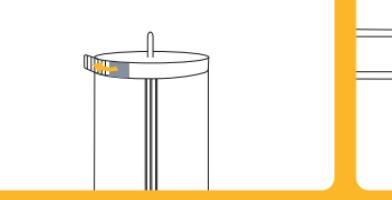
13) Insérer l'arbre de moteur dans l'alésage de la poulie d'entraînement.
