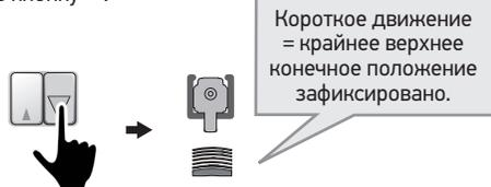
❗ Если крайнее верхнее конечное положение автоматически изменилось в ходе цикла, активируется функция автоматической перенастройки.
